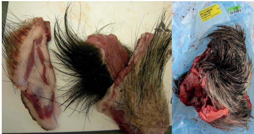
Abbildung 3: Wildschweinprobe mit deutlichem geringem Muskelanteil für die Radioaktivitätsmessung. Cäsium-137 findet sich hauptsächlich im Muskelgewebe. Probenmaterial mit größeren Anteilen an Fett, Bindegewebe oder Schwarte ist für die Messung ungeeignet.
